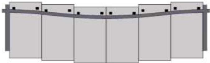
Figuur 2 het effect van doorbuiging van de vloerconstructie voor de elementengevel (met doken)
