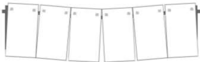
Figuur 2 het effect van doorbuiging van de vloerconstructie voor de elementengevel (met doken)
